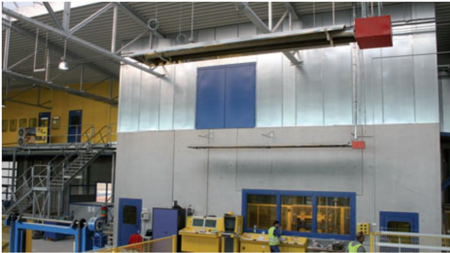
Blick auf die Schallschutzeinhausung der Steinformmaschine sowie auf den Maschinen-Steuerstand
