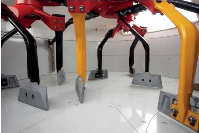
Gegenläufig-drehende Mischsterne im Teka Planetenmischer für intensivste Durchmischung
