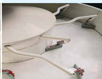
Ringtrogmischer THZ • Turbine pan-type mixer THZ
