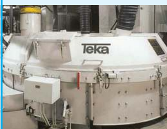
Ringtrogmischer THZ • Turbine pan-type mixer THZ
