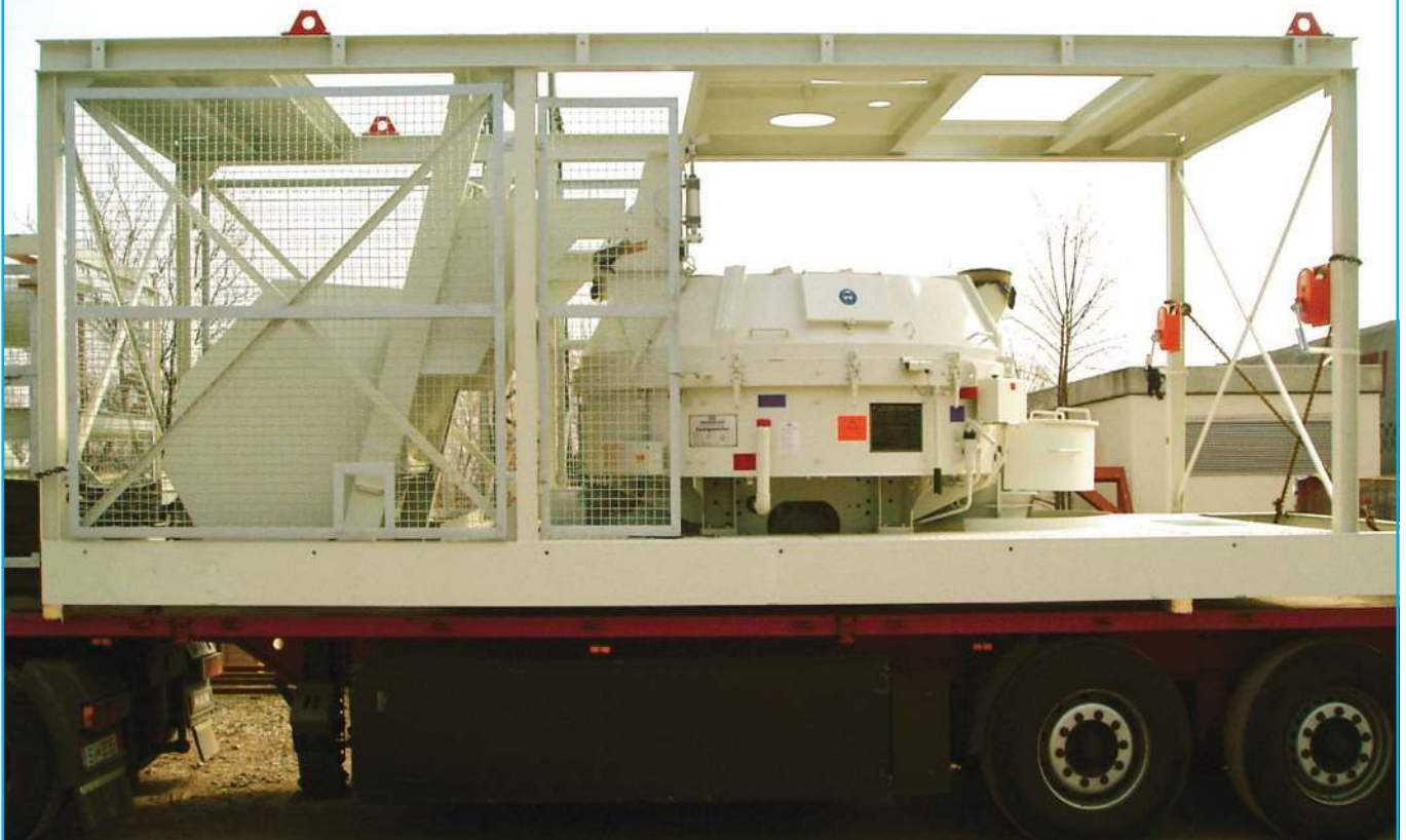
MIXOMAT THZ 1500 B - R Reihensiloanlage, Verladung des Mischer-Moduls • MIXOMAT THZ 1500 B - R aggregate in-line silo system, loading of a mixer module
