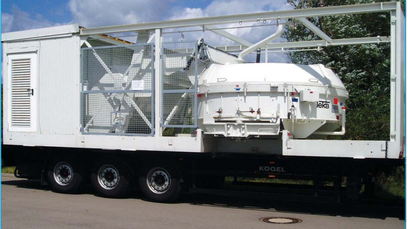
MIXOMAT THZ 3000 C - R Reihensiloanlage, Verladung des Mischer-Moduls • MIXOMAT THZ 3000 C - R aggregate in-line silo system, loading of a mixer module
