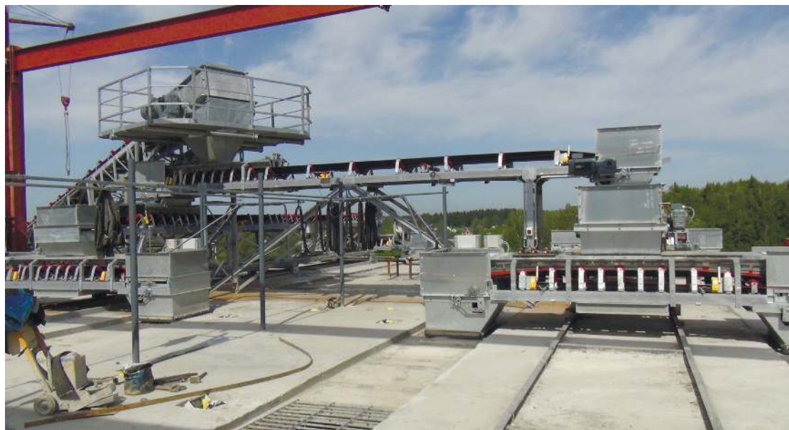
Система загрузки и распределения инертных на складе
