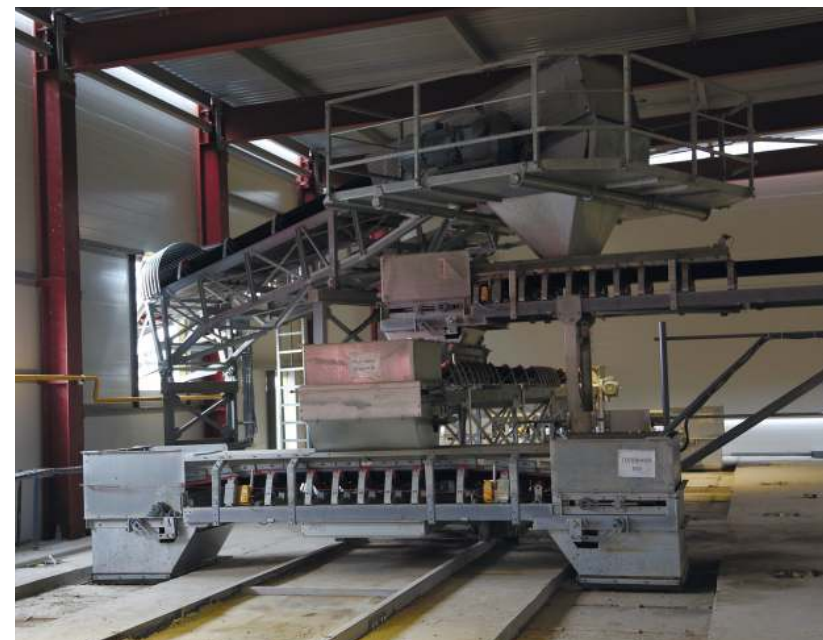
На крыше теплого склада инертных материалов располагается система распределения материала по отдельным бункерам, Тека
