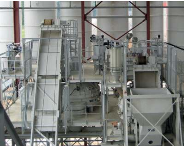
Teka Mischer- und Waagenbühnen mit Bodenentleerbeschicker und Siloanlage im Hintergrund
