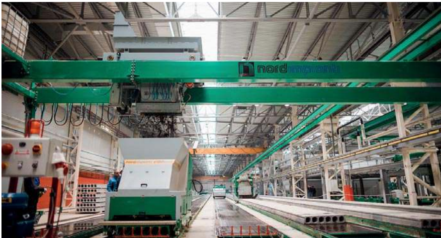
Spannbetonfertigdeckenfertigung von Nordimpianti
