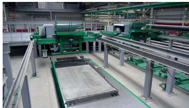
Betonverteiler mit Verdichtungsstation
