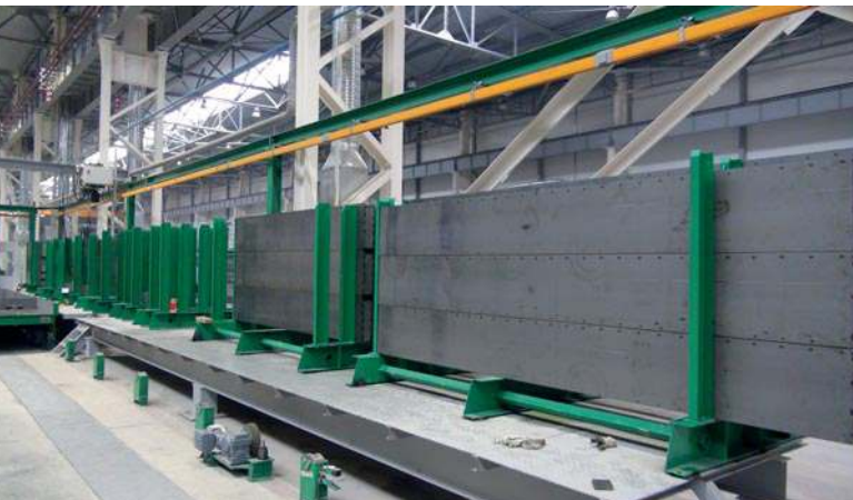
Schalungslager der Weckenmann Schalungsprofil M-Serie
