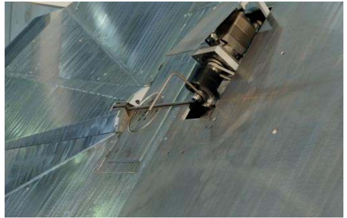
3D Biegemechanismus für die Herstellung von Bügeln und Bewehrungsstäben
