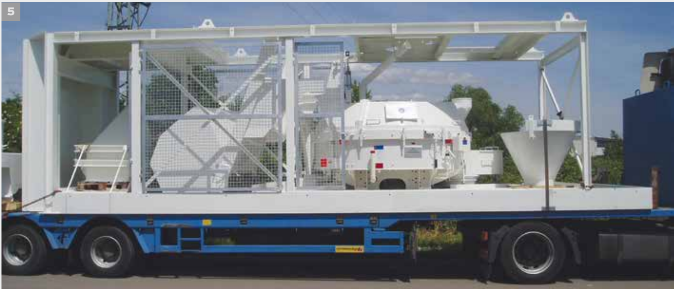
5 | Transport MIXOMAT THZ 1500 B - S 5 Sternanlage mit TEKA Hochleistungs-Ring-trogmischer und Zubehör.
