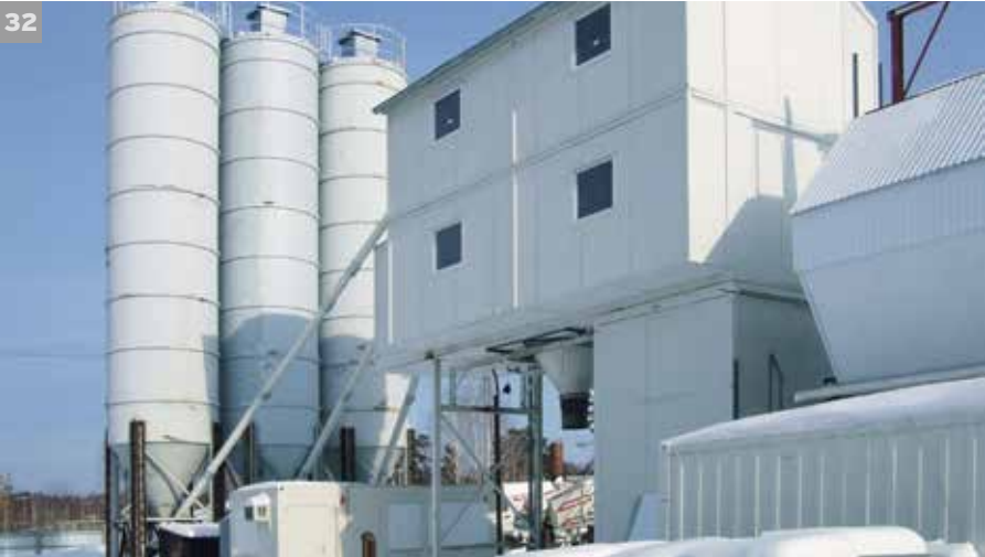
32-34 | Schnell versetzbare MIXOMAT TDZ 3500 D-R inklusive Heizungsanlage für Winterbetrieb
