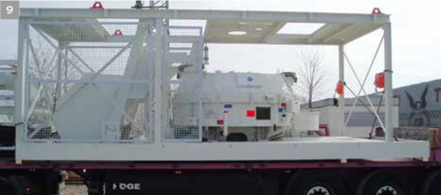
10 | Montage einer MIXOMAT mit TDZ 3000 Doppelwellenmischer.
