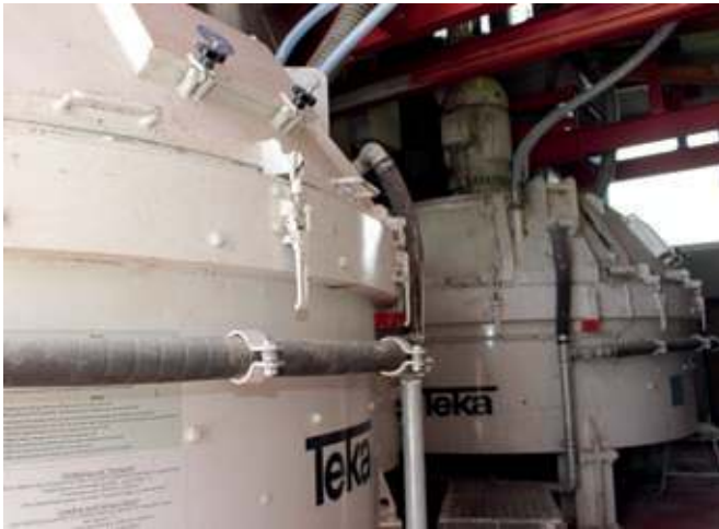
Die zwei Teka Hochleistungs-Turbinenmischer (THT) sind nahezu identisch und können variabel für die zwei Linien auf der Nasseite eingesetzt werden.
