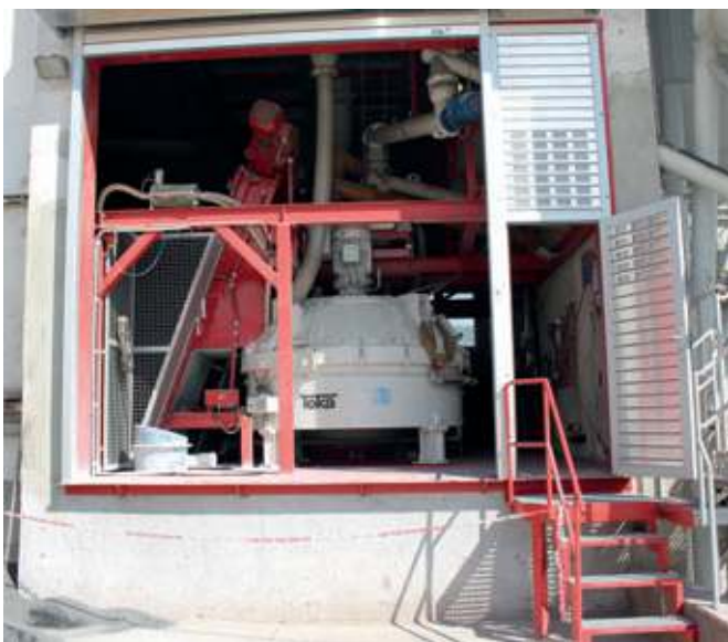
Blick in die modernisierte Mischzentrale mit den zwei Teka Hochleistungs-Turbinenmischer (THT) als Kernkomponenten
