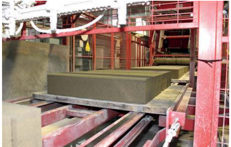
Die HP1000 bietet sich für die Produktion der ganzen Breite von Betonbaustoffen wie Pflastersteine, Bordsteine, Betonplatten, Mauer-Hohlblocksteine oder Gartenelemente an.
