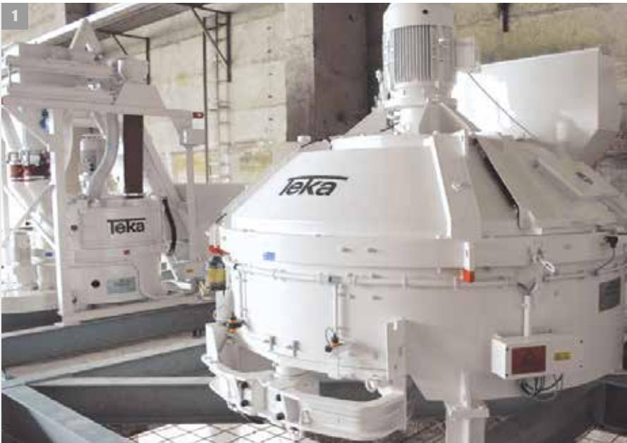
1 | Le THT est spécialement dédié aux parements, béton fibré, béton cellulaire, béton auto-plaçant, béton coloré, béton fibré ultra haute performance. Le malaxeur à turbine est également prévu pour les petites gâchées afin de malaxer de façon optimale de la valeur nominale jusqu'à de très petites
