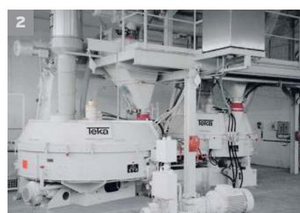
Durante el proceso de carga y descarga, cada agitador funciona con el número de revoluciones en régimen de marcha sin carga. El accionamiento se realiza por separado, mediante una unidad hidráulica.
