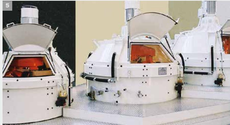
excepción de la TPZ 250 (motor eléctrico). La compuerta de descarga se abre con cualquier ángulo deertura, amplia boca de descarga para una descarga rápida, montaje protegido contra la contaminación de interruptores de fin de carrera con sensores de proximidad
