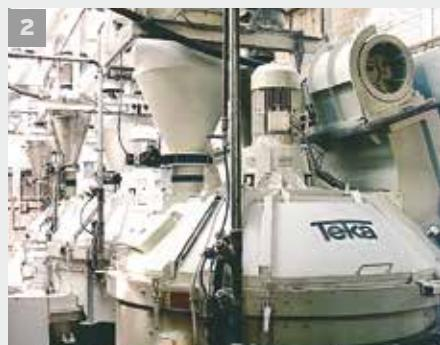
(ouverture par moteur électrique). Ouverture de la porte segmentée, grande porte de vidange pour vidange rapide, détecteur de fin de course protégé des projections.
