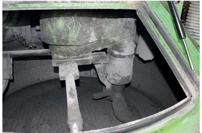
Der speziell entwickelte Abstreifer an der Welle wird jetzt serienmäßig in allen Turbinenmischern eingebaut.
