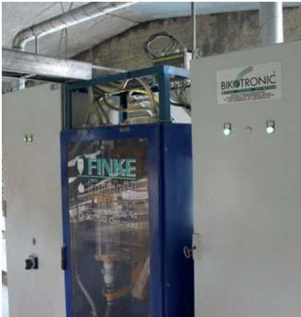
Die Dosierung der Zusatzmittel übernimmt die Anlage von Finke mit Sichtkontroll-Wiegebehälter im staubdichten Schrankeinbau.
