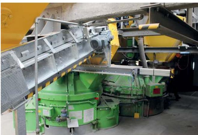
Gesamtblick auf die Mischerebene: Teka-THT-Hochleistungsturbinenmischer für den Vorsatzbeton und Teka-Planetenmischer TPZ 1125 für den Kernbeton
