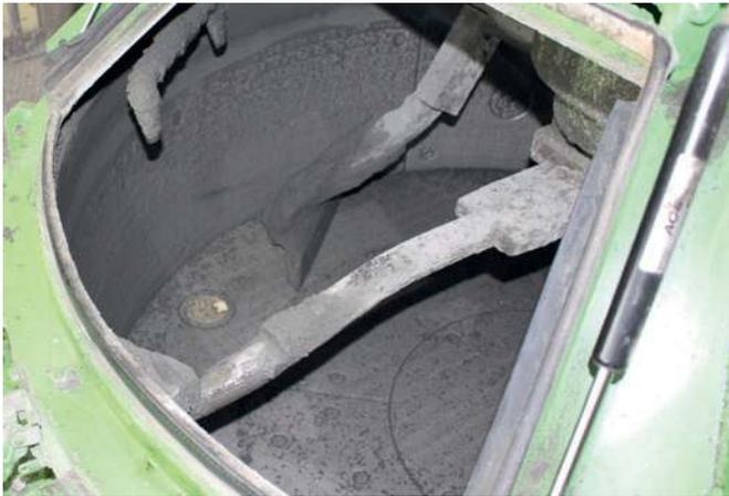
Feuchtigkeitsmesssonde im Mischerboden
