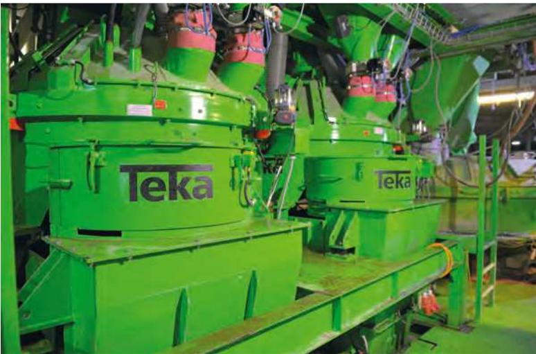
Die zwei Teka Hochleistungs-Turbinenmischer THT E-1-III für hochwertige Vorsatzbetone
