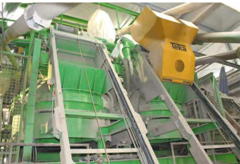
Passend zu den beiden neuen Vorsatzmischern installiert Teka noch zwei Beschickungsaufzüge (500 Liter) in Bodenentleerausführung.
