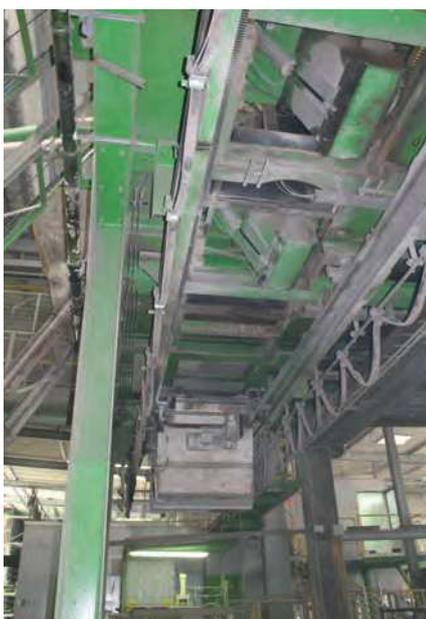
Die neuen Hochleistungs-Turbinenmischer entleeren, wie die Kernbetonmischer, direkt in eine der beiden Kübelbahnen.
