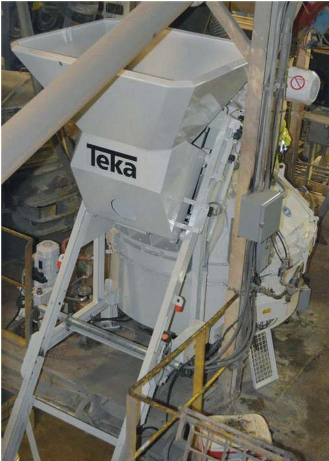
Das Teka-Becherwerk hat eine Bodenentleerung und fährt auf einer Schiene im 60°-Winkel, über die sie den Mischer, der mehr als 50 cm über dem Werksboden ist, schnell mit den Mischmaterialien versorgt.
