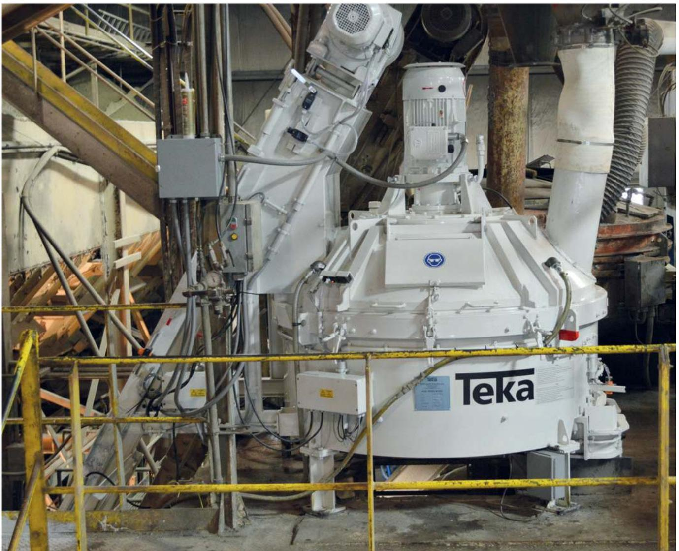
*Doren, Inc. entschied sich für den THT 500 C-1-II Mischer mit einem Teka-Becherwerk. Wie bei allen THT-Mischern ist auch hier ein Frequenzumrichterantrieb Standard, mit dem die Mischgeschwindigkeit der spezifischen Betonrezeptur ideal angepasst werden kann.*
