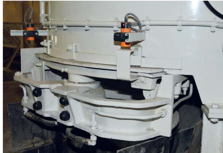
Die Teka-Entleerungsschieber steuert ein leistungsstarker Drehzylinder. Bei Bedarf können Näherungsschalter eingebaut werden, die eine Teilöffnung des Schiebers erlauben.
