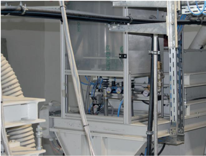
Die Zusatzmittelwaagen befinden sich in einem Schutzschränk aus Aluminiumprofilen mit Plexiglastür
