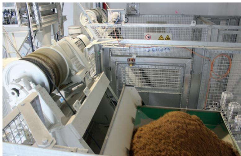
Um die Gesteinskörnungen von der Dosieranlage zu den zwei Ebenen höher installierten Betonmischer zu transportieren, hat Teka auch zwei Beschickungsaufzüge geliefert.
