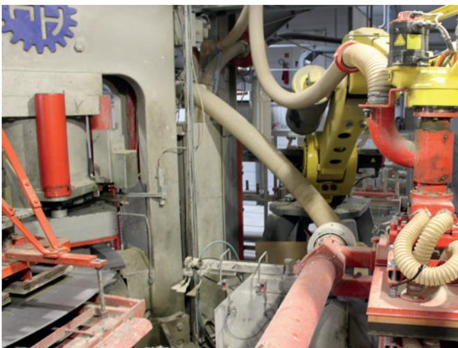
Ein Roboter hebt mit einer Präzision von einem Zehntelmillimeter die frischen Rohlinge sanft und formstabil von Station zu Station.
