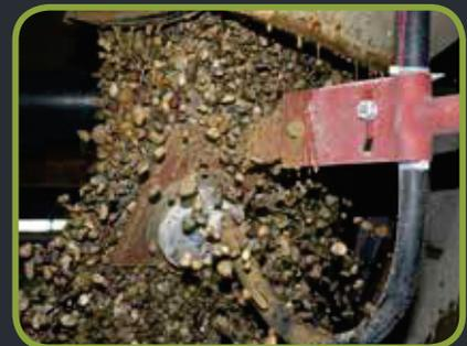
SONO-VARIO Xtrem - Langzeitstabile Feuchtemessung von Kieszuschlägen 8-32mm
