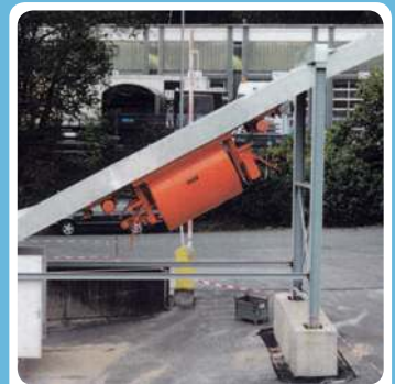
Drehkübel 3.500 l in Steigung 32° = 60%
