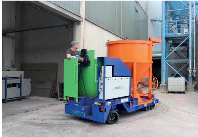
Die Verteilung des Betons in der Produktion erfolgt mittels Kübel und Kranbahn in der Haupthalle. Der Transport der Kübel in die Nebenhalle erfolgt mit einem Elektroplattformwagen von Muli-Trans.
