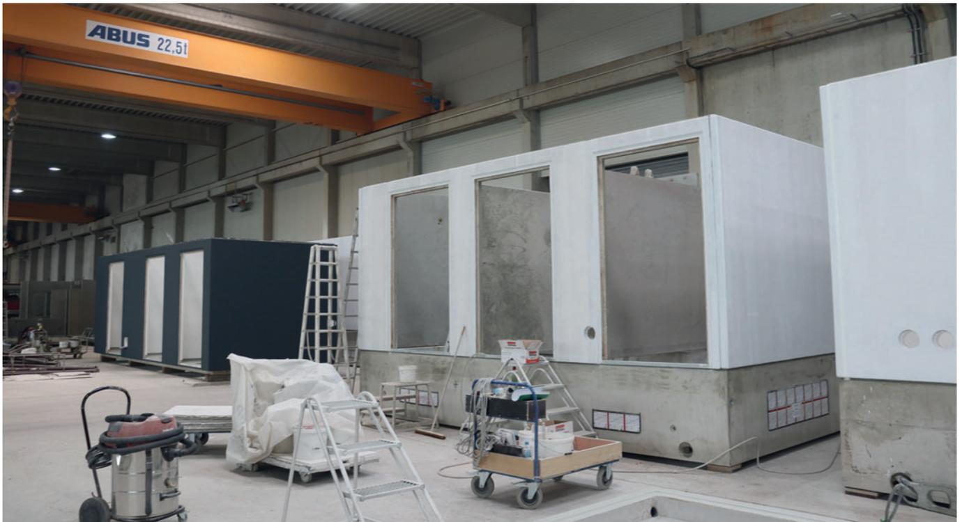
*Durchschnittlich fließen 150 Mannstunden in eine Trafostation, bis diese versandfertig ist.*
