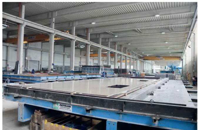
Die Umlaufanlage zur Decken- und Doppelwandfertigung wurde seinerzeit von Avermann geliefert.
