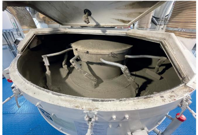
Die Mischarme sind höhenverstellbar und federnd im Rotorgehäuse gelagert.
