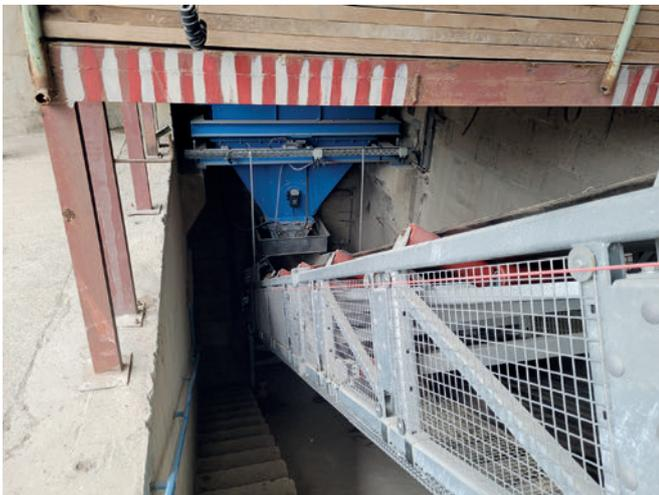
Neue Behälterwaage mit einer maximalen Wiegefähigkeit von 4.000 kg
